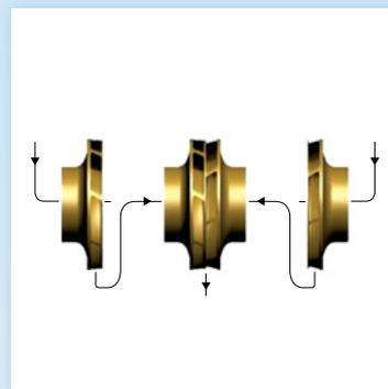
**2D** Design à deux étages, à double aspiration, avec deux roues à aspiration simple en série et une roue à double aspiration entre les deux. Disponible également en 3D
