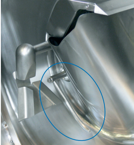
▲ In der Zentrifuge installiertes FCA-System (Feed Control Analog)
