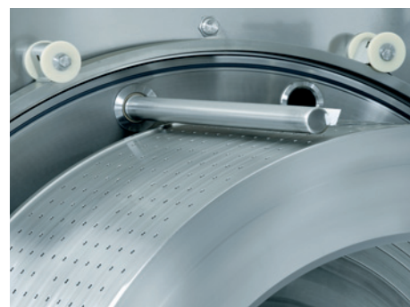
▲ Pneumatische Entfernung der Grundschicht
