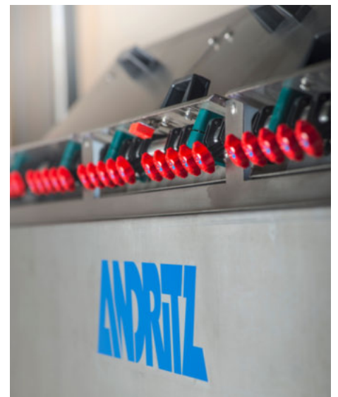
▲ Rampa di lavaggio con accesso rapido
