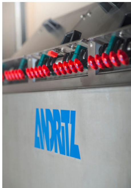
▲ 快速检查清洗喷淋装置
