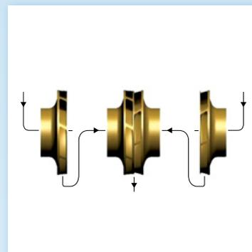
**2D** Doppelstufig, doppelflutig, mit zwei einflutigen Laufrädern auf beiden Seiten und einem doppelflutigen Laufrad in der Mitte; auch verfügbar in 3D Anordnung
