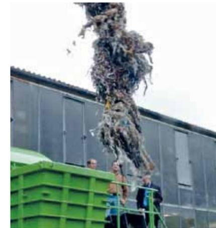
Altpapier wird üblicherweise in gepressten, mit Draht in Form gehaltenen Ballen im Papierwerk angeliefert. Beim Stoffaufbereitungsprozess bilden sich unter anderem Zöpfe, die aus Draht und sogenannten Spuckstoffen bestehen. Spuckstoffe sind alle Materialien, die nicht aus Papier bestehen, wie Kunststoffe, Textilien, Metalle.
