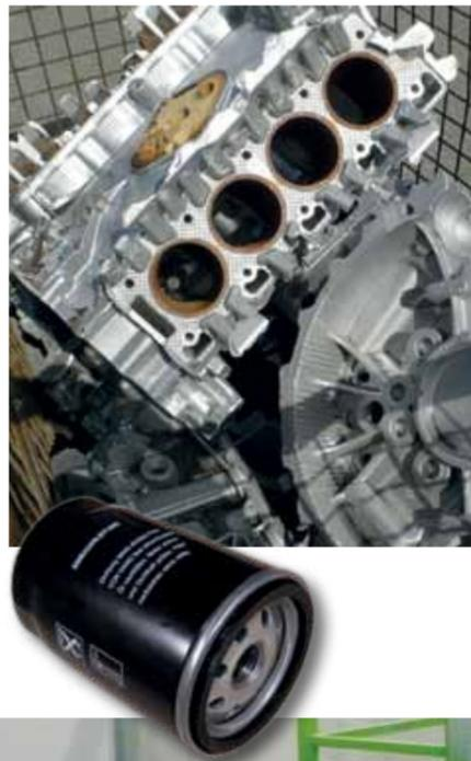
Ausgetauschte PKW- und LKW-Ölfilter gelten europaweit als Sondermüll. Sie bestehen aber zu gut 60% aus Metallen (hauptsächlich Eisen). Das Öl macht etwa 20% des Materialgemisches aus. Der eigentliche Papierfilter, Gummimanschetten und weitere Kunststoffteile bilden den Rest.
