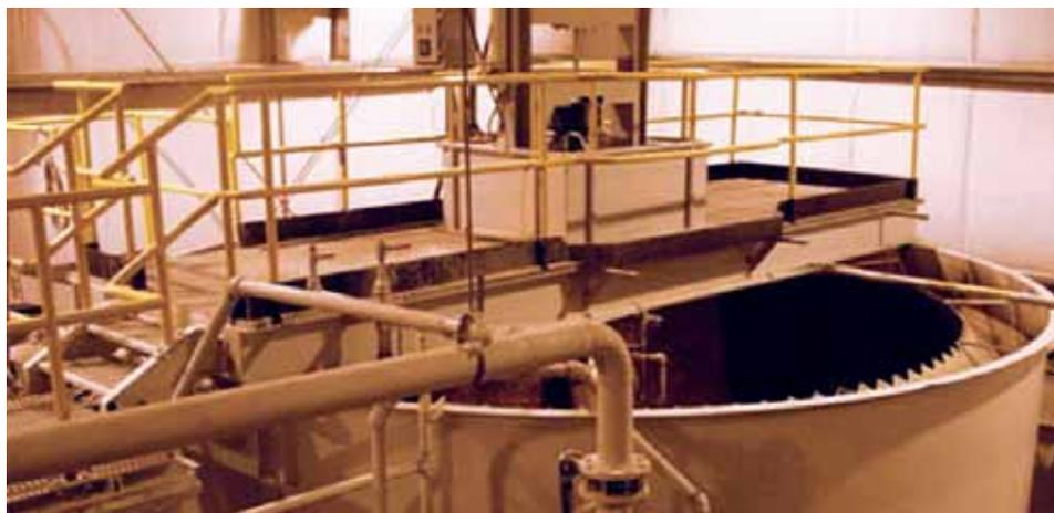
регулируется путем контроля крутящего момента на скребке и непрерывной корректировки плановой плотности в пределах предварительно заданного диапазона. В свою очередь, плотность продукта поддерживается путем изменения скорости его выгрузки из сгустителя.
