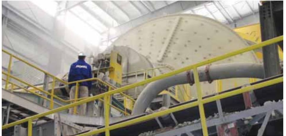
мельницы, а также качества руды и рециркулирующей гальки, BrainWave поддерживает постоянный вес мельницы и максимизирует производительность. Пока весовой контроллер регулирует уставку для подачи свежей руды, второй контроллер BrainWave регулирует скорость работы питателя, обеспечивая доставку в мельницу нужного количества материала.
