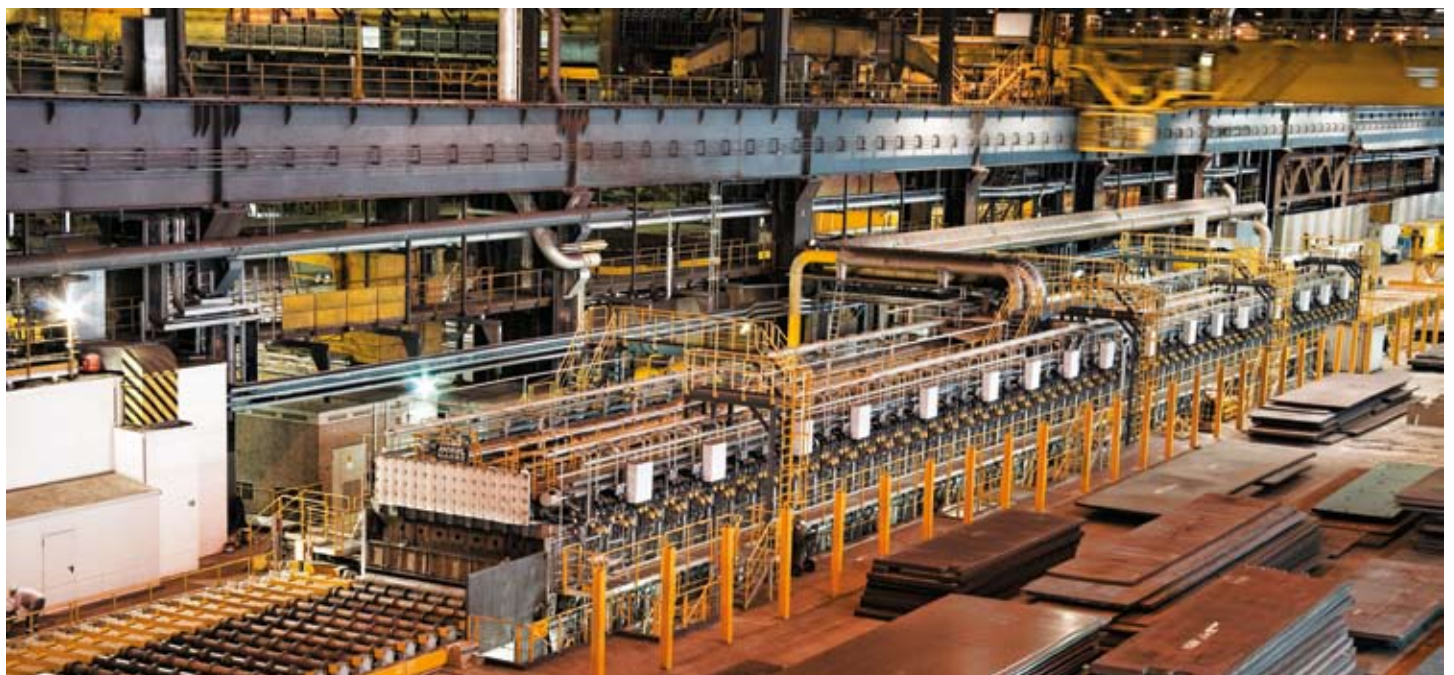
Rollenherdöfen (ca. 80 m) zur Wärmebehandlung von Grobblech bei der AG der Dillinger Hüttenwerke, Deutschland. Roller hearth furnace (approx. 80 m) for heat treatment of heavy plates at AG der Dillinger Hüttenwerke, Germany.
