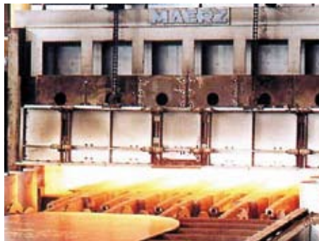
Rollenherdöfen (ca. 80 m) zur Wärmebehandlung von Grobblech bei der AG der Dillinger Hüttenwerke, Deutschland. Roller hearth furnace (approx. 80 m) for heat treatment of heavy plates at AG der Dillinger Hüttenwerke, Germany.
