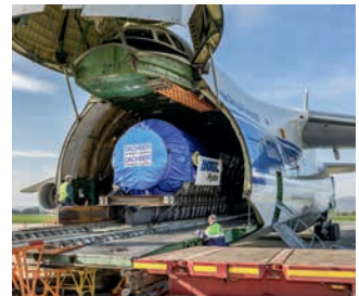
Turbogenerator, USA Transport eines 90 Tonnen schweren Turbogenerators mit einem der größten Flugzeuge der Welt – Antonov 124 2013
