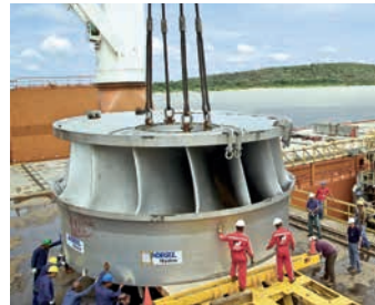
Simón Bolívar (Guri II), Venezuela Weltweit größte Francisturbinen (5 × 770 MW) für das größte Wasserkraftwerk Venezuelas 2006
